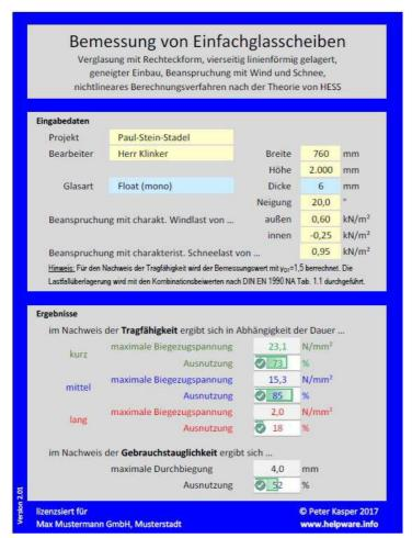
Das Modul "DW1" ist geeignet, rechteckförmige Einfachverglasungen mit vierseitig linienförmiger Lagerung unter Schnee- und Windlasten nachzuweisen. Dazu wird auf die Theorie von HESS zurückgegriffen, die es ermöglicht, besonders bei dünnen Scheiben günstig wirkende Membranspannungen zu aktivieren, die der eigentlichen Biegespannung entgegenwirken. Im Ergebnis lassen sich bessere Ausnutzungen erzielen.
